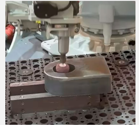
Anschnittfahnen in kleinen Bohrungen
